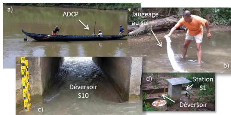
Figure 12 a) Jaugeage à l'ADCP à Ban Mout (Nam Khan) ; b) Jaugeage au sel en A6-A1 (Houay Khan) ; c) Echelle et déversoir en S10 (Houay Xon); d) Déversoir en S1 (HX)
