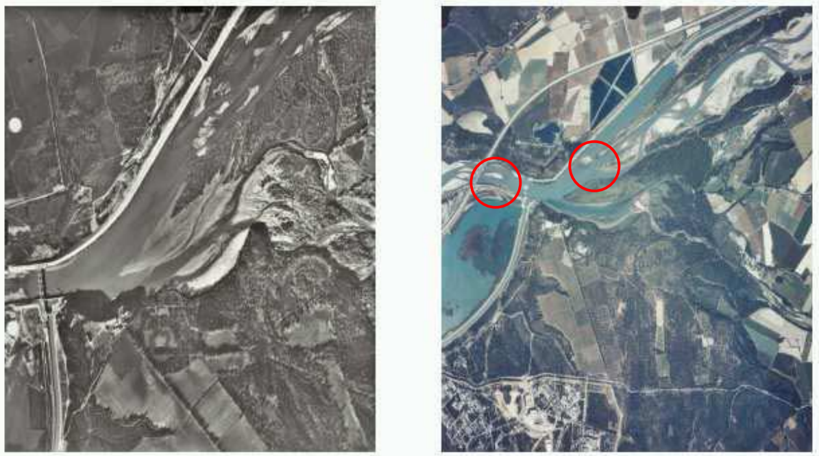
Figure 7 : Photo aérienne de la retenue de Cadarache : 1963 (gauche) 2001 (droite). L'envasement est nettement visible (cercles rouges)
